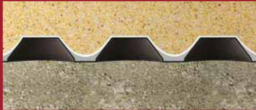
Поведение иглопробивного геотекстиля, скрепленного с выступами дренажного ядра
