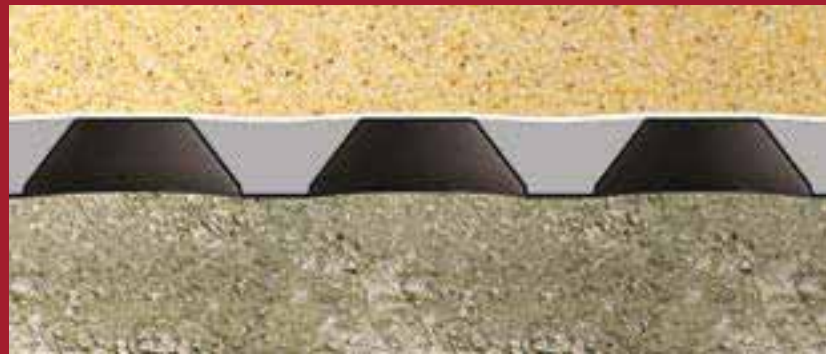
Поведение геотекстиля Тураг, скрепленного с выступами дренажного ядра
